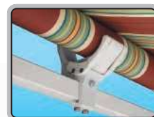
■巻取サポート 【特許出願済】 ※巻取サポートはポリエステル系キャンバス使用時の設定を推奨します。 2 ピース構造の採用により、取付取外し及びメンテナンスも容易です。抜け出し防止の形状で巻取パイプのたわみ・はずれを防止します。回転ベルトのガイドにより、キャンバスの耐久性を高めています。
